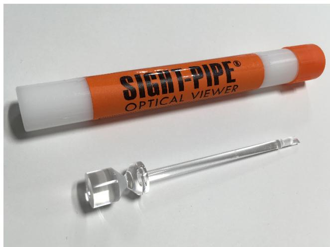
SIGHT PIPE® は、円周溶接機で製作された内部溶接ビードの目視検査に最適です。
