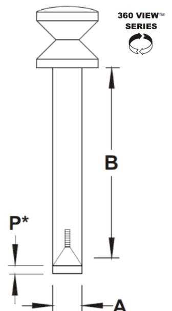
SPT360シリーズには、底付きから SIGHT PIPE® を保護および、傷から守るために末端にDelrin樹脂“PILOT”が使われています。外径が減少した溶接面を検査する場合、P寸法の適切な長さについてお問合せください。
